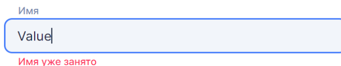
Рис. 3.63. Предупреждение наименования объекта, название занято
